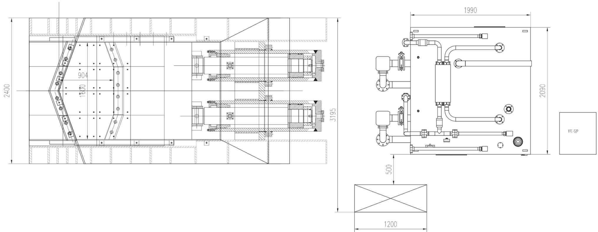
Schrottschere MS-6300md – mobile Ausführung, Dieselaggregat, Seitenansicht
