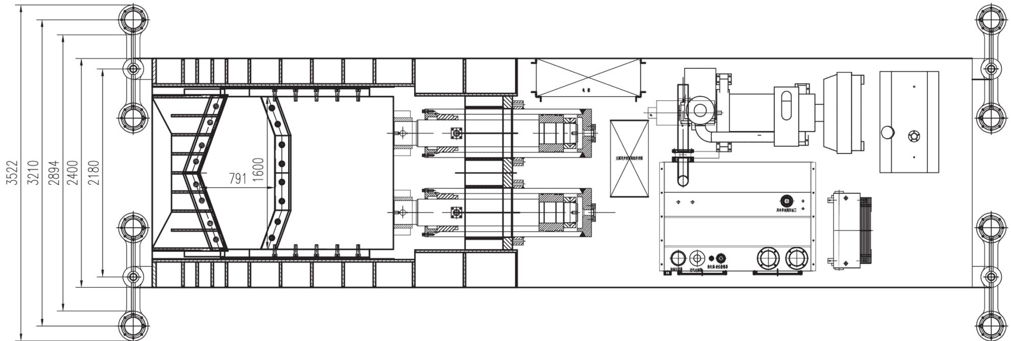
Schrottschere MS-6300me – mobile Ausführung, elektrisch angetrieben, Seitenansicht
